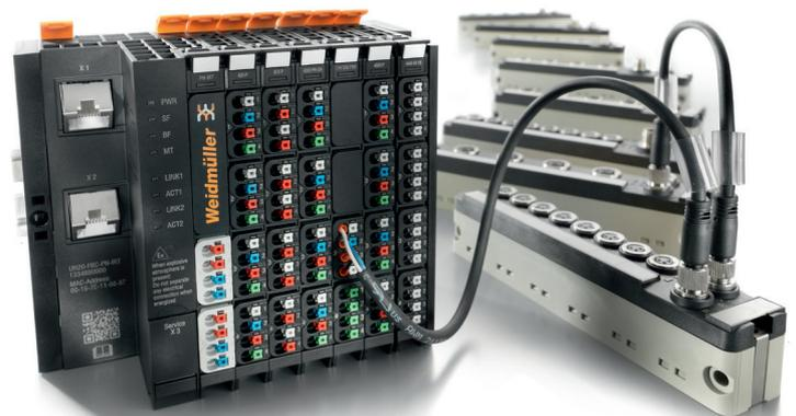
Das System kann auch für sicherheitstechnische Applikationen eingesetzt werden. Dabei kommen die u-remote Safety-Powerfeed-Module zum Einsatz, die unabhängig von der Steuerung die Maschinen in einen sicheren Zustand versetzen. Die notwendigen nicht sicheren Signale für das Applikationsprogramm werden über den u-remote Rückwand-bus an u-control 2000 übertragen und dort verarbeitet.
