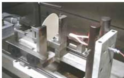
Abbildung 3: Beispiel Glühdrahtprüfung
