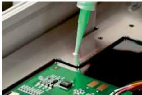
Das Montageverfahren gleicht Maß- und Bearbeitungstoleranzen sowie thermische Ausdehnungseffekte oder mechanische Belastungen wie Vibrationen auf effektive Weise aus.
